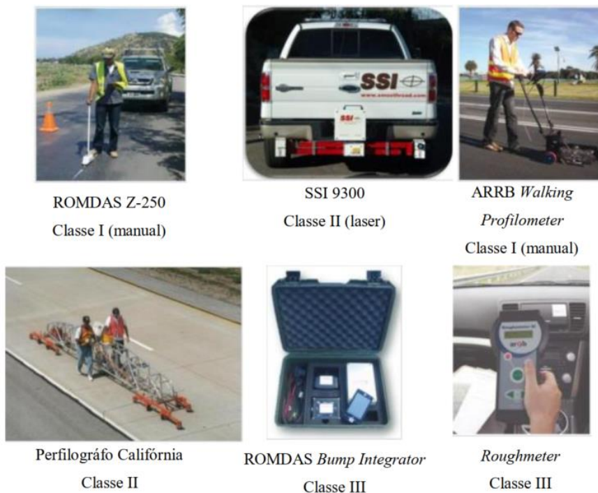
Figura 3: Equipamentos utilizados para medir a irregularidade longitudinal (Almeida, 2018)
